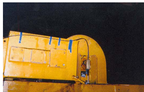
Extensomètre optique sous un palier de tambour, déterminant sa réaction d'appui
