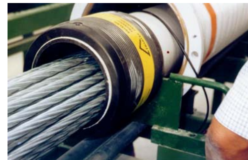
Intégration des Cordes Optiques dans les tirants
